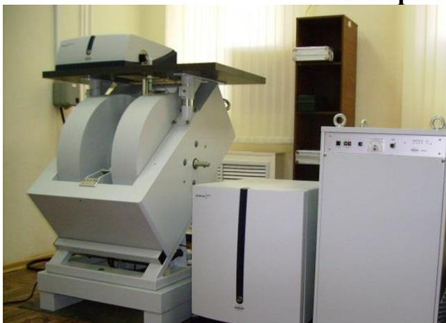
Для исследования в стационарном режиме стабильных парамагнитных центров в X-диапазоне (9.4ГГц).
