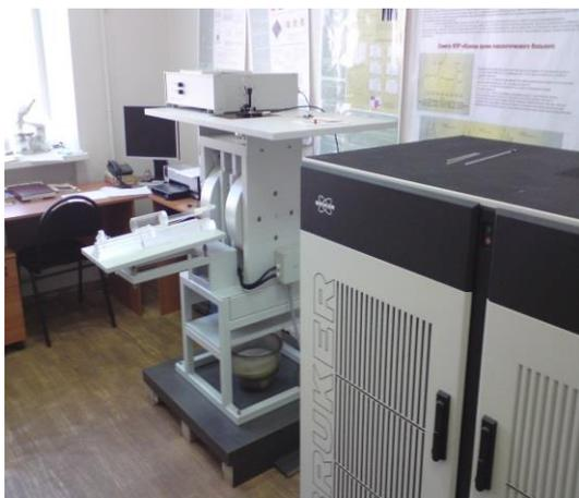
Спектрометр ELEXSYS E540, работающий в L-диапазоне на частоте 1 ГГц, снабженный устройством для ЭПР-томографии и оптимизированный для исследования биологических объектов (Отв. М.М. Ахметов)
