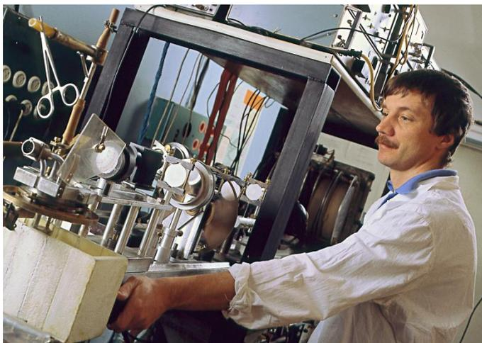
Высокочастотный спектрометр, рабочая частота которого может плавно перестраиваться в диапазоне 65 – 1250 ГГц. В качестве генераторов микроволнового излучения в этом спектрометре используются лампы обратной волны производства НПО "Исток", г. Фрязино. Отв. В.Ф. Тарасов, д.ф.-м.н., Г.С. Шакуров, д.ф.-м.н.
