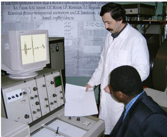
Для исследования в стационарном режиме в X (9,3 ГГц) и Q (37 ГГц) диапазонах и при температурах 4,2, 77 К и 300 – 500 К. Имеется приставка ДЭЯР.
