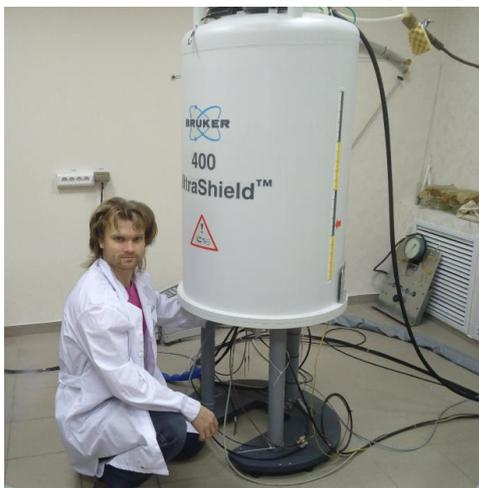
Многоядерный Фурье-спектрометр с частотой для ядер водорода 400 МГц. Позволяет получать одномерные и двумерные спектры ЯМР высокого разрешения для веществ в твёрдом и жидком состояниях. Возможно снятие спектров с динамической развязкой, измерение коэффициента диффузии с использованием встроенного градиента магнитного поля, а также времён магнитной релаксации. Отв. Конов А.Б., к.ф.-м.н., Волков М.Ю., к.ф.-м.н.
