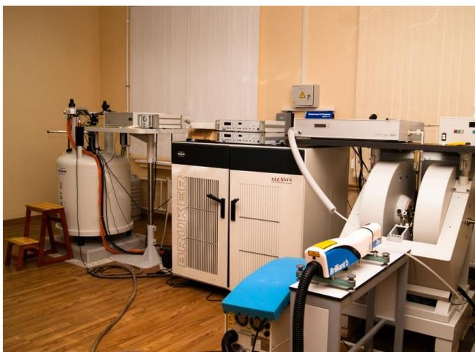
Современный стационарный/импульсный спектрометр ЭПР X/W частотных диапазонов (9.4/94ГГц)
