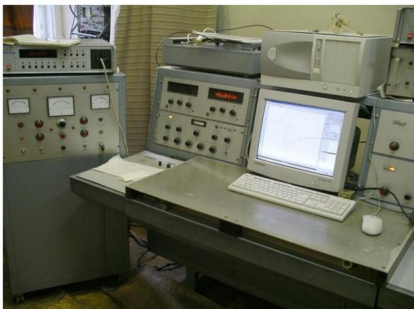
Спектрометр ЭПР BER 418 S производства фирмы "Bruker", Германия, в 2008 г. оснащен специализированным криостатом производства РИЦ "Курчатовский институт", позволяющим проводить измерения при сверхнизких температурах до 0,4 К. Отв. Валидов А.А., к.ф.м.н.
